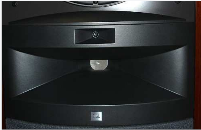
Garant für hohe Pegelfestigkeit: Hochtöner und Superhochtöner integriert in ein Gehäuse, ausgeführt als Horn
