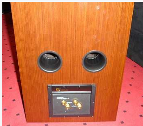
Die Rückseite der K2 S-5800 mit den beiden Bassreflexöffnungen
