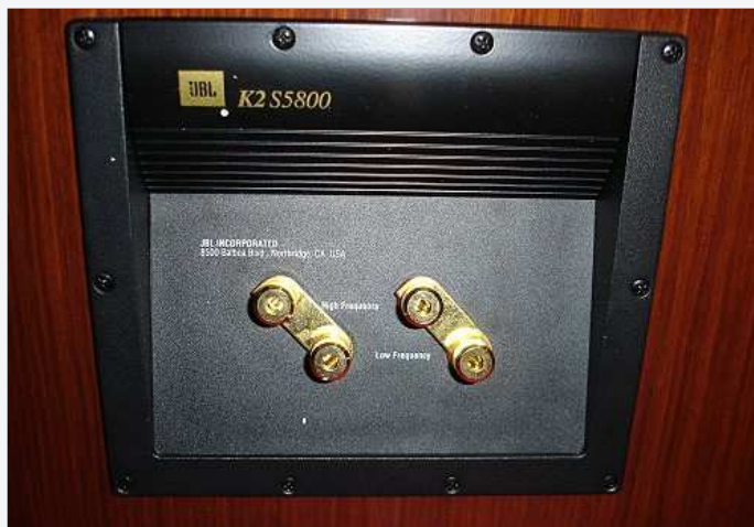
Das geht besser: Sehr einfaches Lautsprecherkabel-Anschlussterminal
